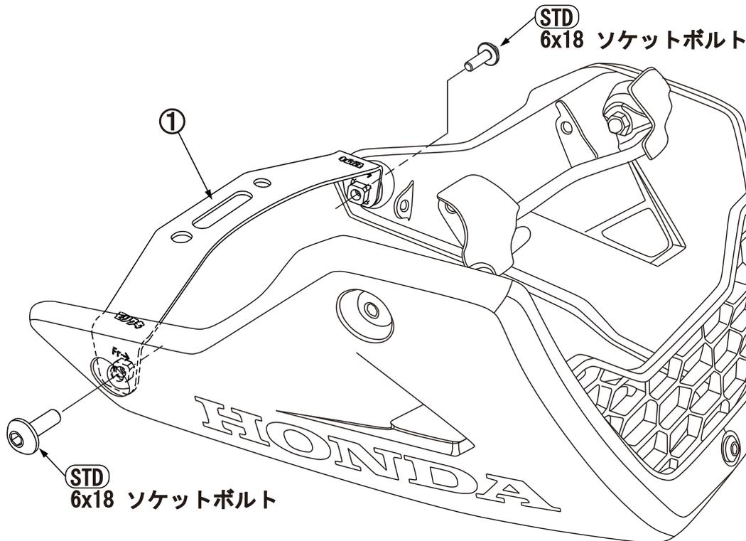
※図中「STD」とは車両メーカーの純正オプション部品の事です。製品取り付けに使用します。
