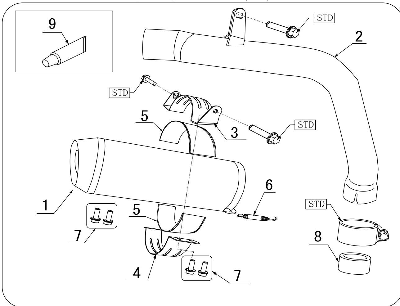
※図中「STD」とは車両メーカーの純正部品の事です。製品取り付けに再使用します。
