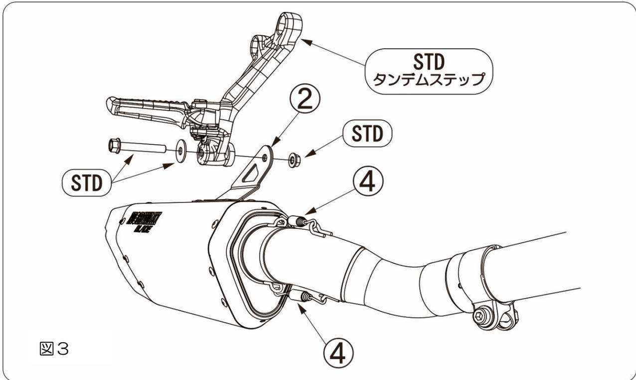
• 仮組後、スプリングショート (部品④) を取り付けて下さい。(図.3 参照)
