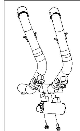
④ テールパイプ（構成部品 3）のフロントパイプ差し込み口に ME30（構成部品 16）を適量塗布し、
